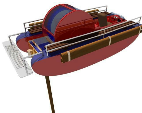
Ryc. 1 Mobilny aerator pulweryzacyjny opracowany w Akademii Rolniczej w Poznaniu
